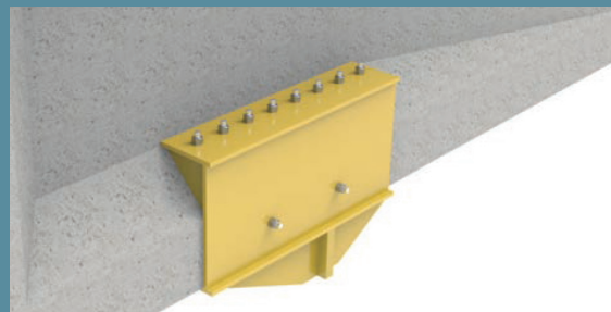
3 정착부 브라켓 조립 및 긴장력 도입
